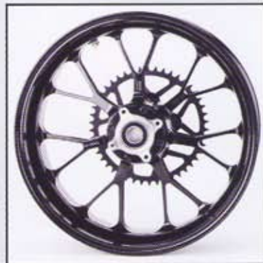
PVM 7 Y Speichen Rad, geschmiedet aus Mg nur für den Rennsport
